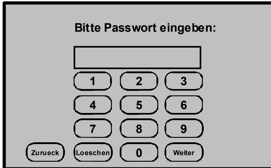
Abbildung 6 GMD400 Passworteingabe, um ins Kalibrationsmenü zu gelangen
